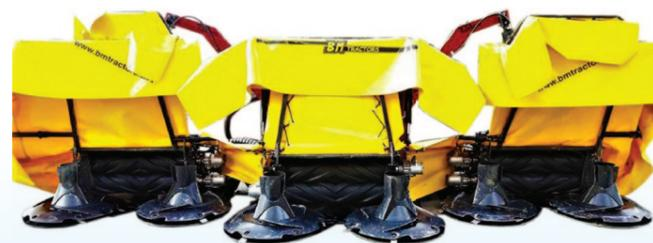
Lo sfalcio di 5,30 metri è diviso in 3 andane equidistanti che permettono il passaggio del trattore senza calpestare il prodotto. Ogni settore è composto da 2 dischi (1,76 metri), i quali introducono il prodotto direttamente nel condizionatore abbinato, riducendo notevolmente il tempo di essiccazione.
