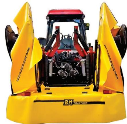
6 dischi indipendenti azionati da trasmissione idraulica. 3 condizionatori con rulli in gomma indipendenti azionati da motori idraulici.
