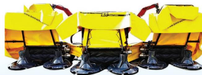
Lo sfalcio di 6,60 metri è diviso in 3 andane equidistanti che permettono il passaggio del trattore senza calpestare il prodotto. Ogni settore è composto da 2 dischi (2,20 metri), i quali introducono il prodotto direttamente nel condizionatore abbinato, riducendo notevolmente il tempo di essiccazione.
