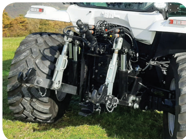
Applicazione per l'aggancio rapido degli attrezzi. Application for quick coupling of implements. Application pour l'accrochage rapide des outils. Vorrichtung für Schnellanschluss der Anbaugeräte.
