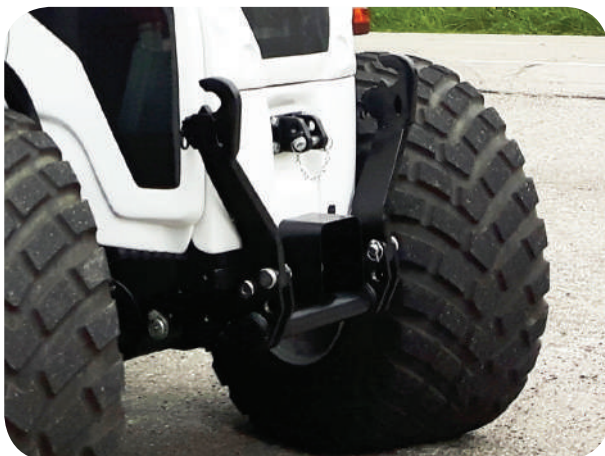
Presa di forza frontale e sollevatore anteriore con bracci removibili. Front power take-off and front hitch with removable arms. Prise de force frontale et système de relevage antérieur avec bras mobiles. Nebenabtrieb und Frontlader mit abnehmbaren Armen.
