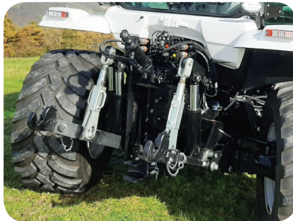
Presa di forza posteriore e sollevatore con 3° punto idraulico. Rear power take-off and power lift with 3rd hydraulic point. Prise de force arrière et relevage électrique avec 3ème point hydraulique. Heckapfswelle und Kraftheber mit hydraulischem 3.
