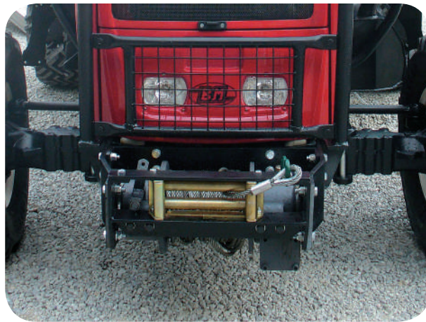
Application with 5700 kg frontal winch. Wciągarka przednia o udźwigu 5700 kg.
