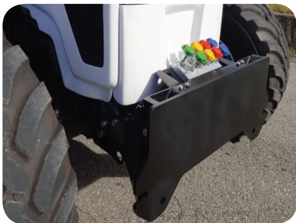
Front bracket with UNI plate for snow plough. Wspornik przedni z płytą UNI do pługa śnieżnego.
