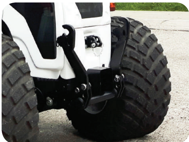
Front power take-off and front hitch with removable arms. Przedni WOM i przedni zaczep 3-punktowy ze zdejmowanymi ramionami.
