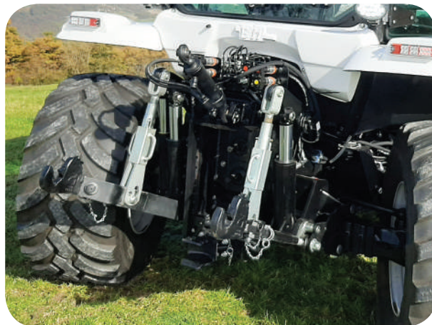
Rear power take-off and power lift with 3rd hydraulic point. Tylny WOM i 3-punktowy podnośnik z hydraulicznym ciąglem.
